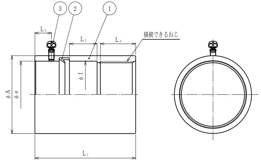
注) 1. 厚鋼電線管をねじなしで接続する、厚鋼電線管めねじを有した鋼製防水仕様のねじなしカップリングです。
