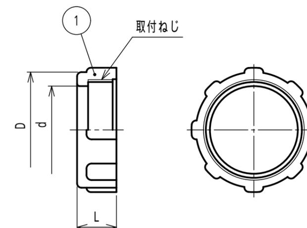
注1. ケーブルを電線管から外部に引出すときケーブルの被覆を損傷させないために厚鋼電線管の管端に取付けるポリカーボネート製の絶縁ブッシングです。
