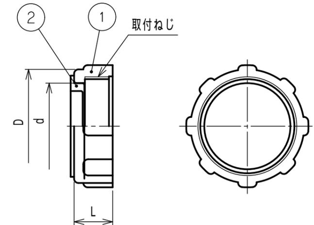
注1. ケーブルを電線管から外部に引出すときケーブルの被覆を損傷させない
