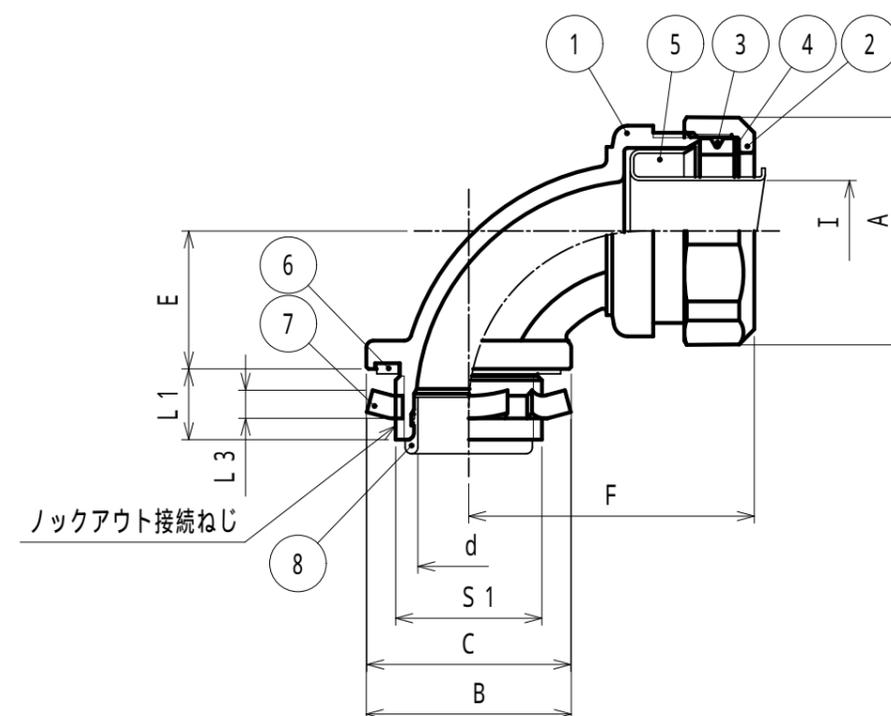
注1. ビニル被覆ケイフレックスをボックス類のロックアウトに接続するための、90形の管用平行ねじ付き亜鉛合金ダイカスト製コネクタです。
