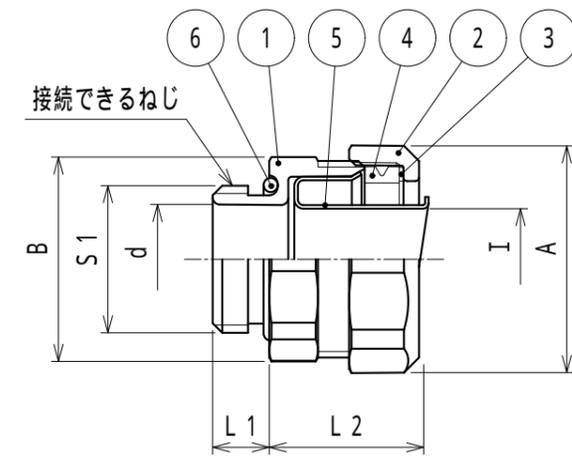
注1. ケイフレックスを電気機器のめねじに接続するための、ストレート形
