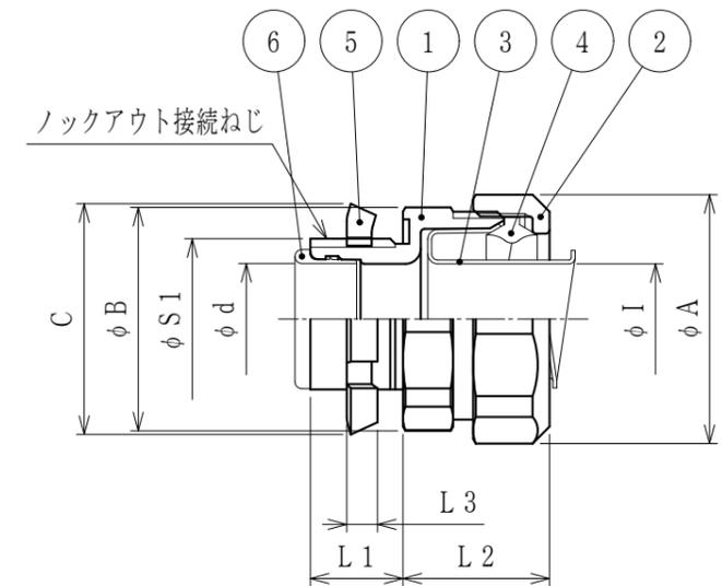
注1. 被覆なしケイフレックスをボックス類のノックアウトに接続するための、ストレート形
