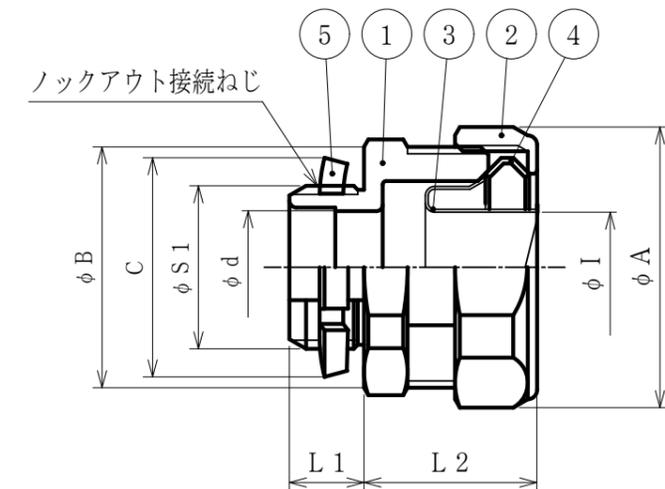
注1. グラスウール入りブレードケイフレックスType LIGBをボックス類のロックアウトに接続するための、ストレート形の管用平行ねじ付き亜鉛合金ダイカスト製コネクタです。
