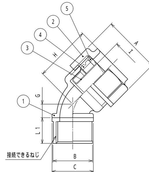
注1. ビニル被覆ケイフレックスをねじ付き厚鋼電線管に接続するための、
