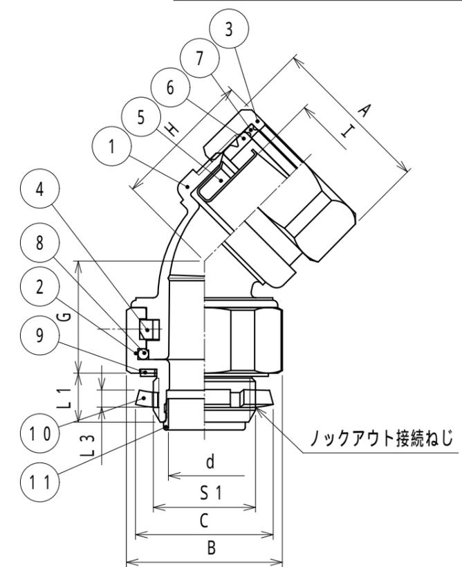
注1. ビニル被覆ケイフレックスをボックス類のロックアウトに接続し、接続方向に対して45°方向に首振りする機能を有した45°形の管用平行ねじ付き亜鉛めっき合金ダイカスト製回転式コネクタです。
