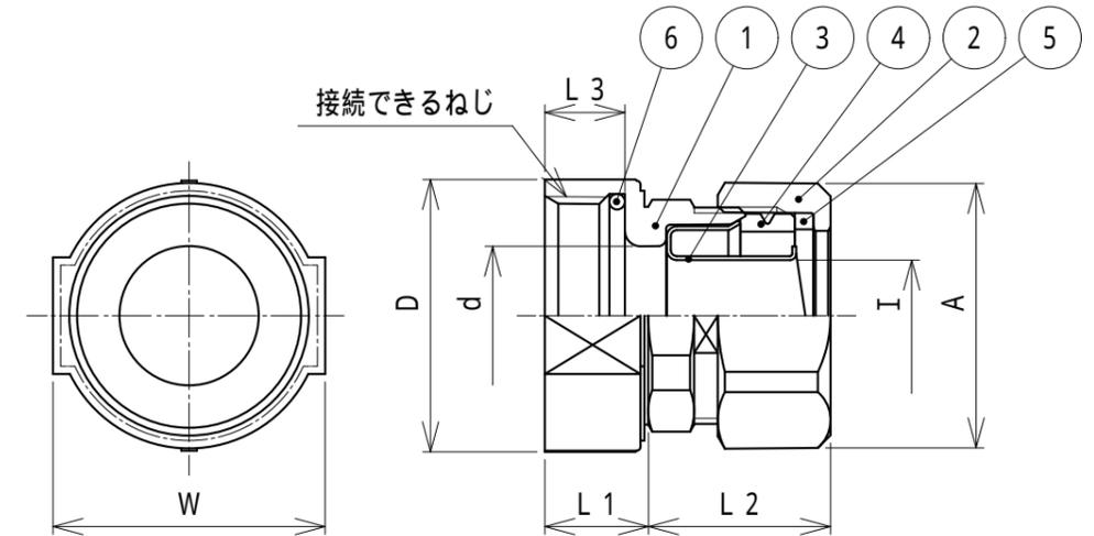
注1. ビニル被覆ケイフレックスをバックシェル(又はプラグ)付きのMSコネクタに接続するための、ストレート形の亜鉛合金ダイカスト製カップリングです。
