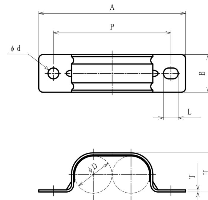
注1. ケイフレックスを造管材に固定するための、鋼製2本止めサドルです。
