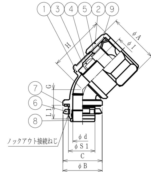
注1. ビニル被覆・ブレードケイフレックスType KPFBをボックス類のノックアウトに接続するための、45°形の管用平行ねじ付き亜鉛合金ダイカスト製コネクタです。
