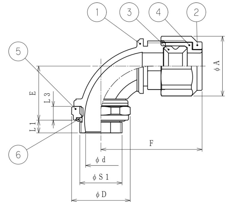
注1. ケーブルをリミットスイッチ等のメートル細目ねじに接続するための、メートル細目ねじ付き90°形金属製シールコネクタです。
