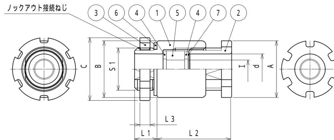
注1. JIS F 8801 船用電線貫通金物 に準拠した亜鉛合金ダイカスト製のケーブルグランドです。
