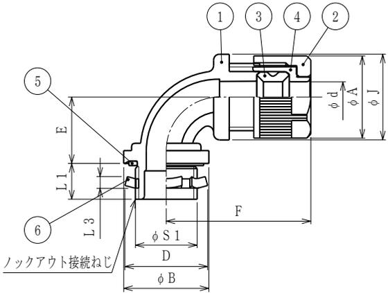
※E 2 9 B G 1 4 1 6 はケーブルφ 1 4 以上からφ 1 6 までは、接続ねじ部の内径を通過する部分のケーブルは、被覆を剥ぎ取って挿入して下さい。
