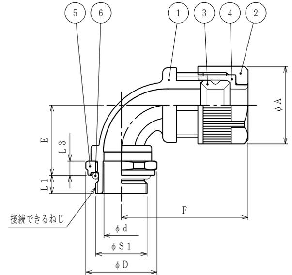
注1. ケーブルをリミットスイッチ等のメートル細目ねじに接続するための、メートル細目ねじ付き90°形樹脂製シールコネクタです。
