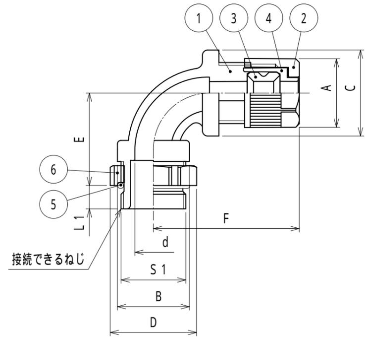
注1. ケーブルをフード・ハウジングなどのPgねじ(DIN規格)に接続するための90°形樹脂製シールコネクタです。
