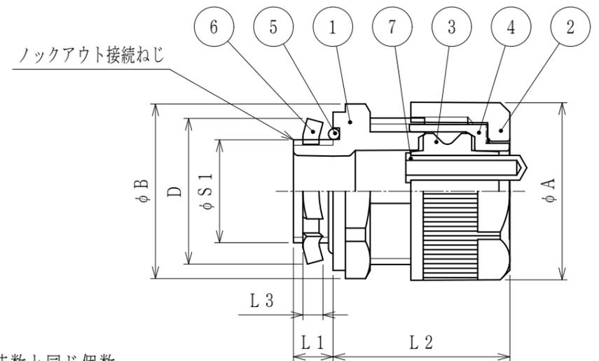
注1. ケーブルをボックス類のロックアウト又はリミットスイッチ等のめねじに接続するための、ストレート形の管用平行ねじ付きマルチ式樹脂製シールコネクタです。
