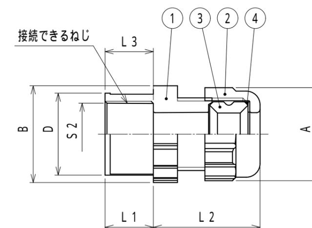
注1. サンパイプType LTの管端部でケーブルをグランドするための、ストレート形のMねじ付き樹脂製シールブッシングです。
