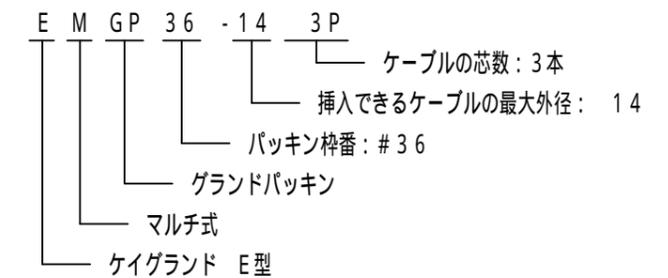
3. C型, C2型, E型, E2型コネクタ及びカップリングのグランドパッキンと交換して使用できます。
