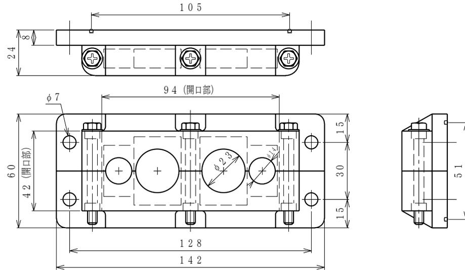
注1. φ14の穴にはEMSと同様に外径φ2~φ13.5のケーブルが、φ23の穴には外径φ7~φ22.5のケーブルとケイフレックス Type KMS16が適応できます。
