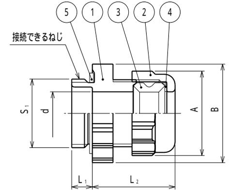
注1. ケーブルをリミットスイッチなどの管用平行ねじに接続するための
