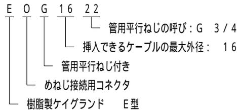
3. EOG 11 12、14 16は、挿入するケーブルの外側シースを剥ぎ取って使用すれば、
