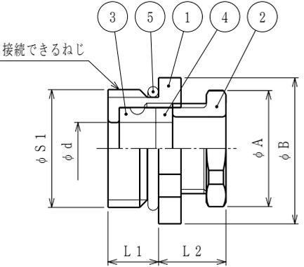
注1. ケーブルをリミットスイッチ等の管用平行めねじに接続するためのストレート形樹脂製シールコネクタです。
