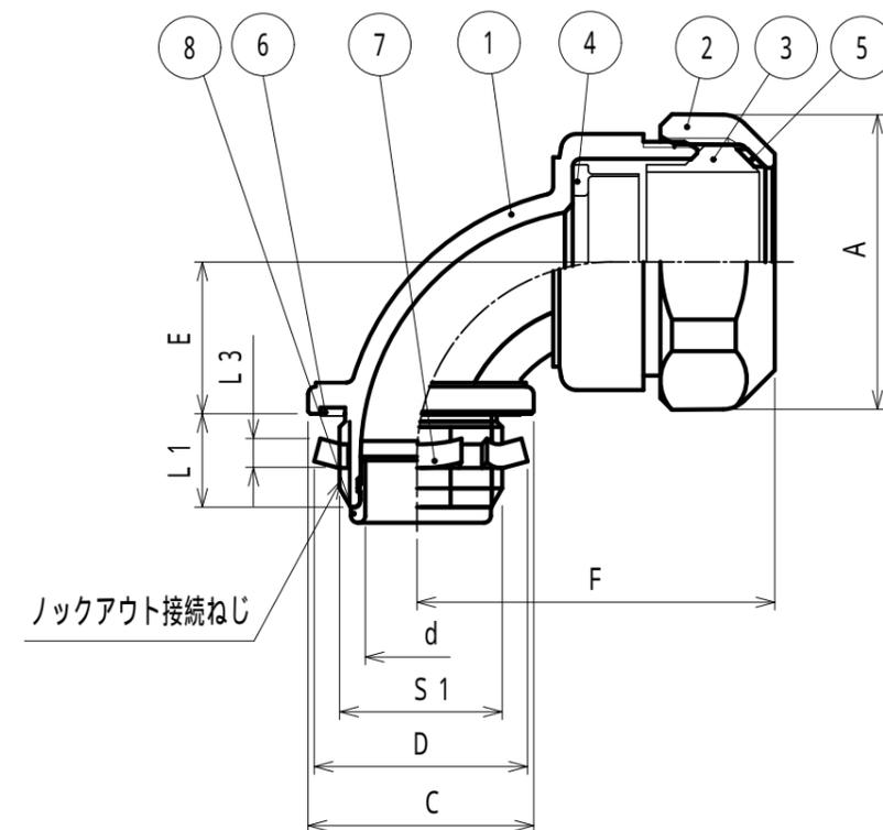
注1. 防水プリカをボックス類のロックアウトに接続するための、90 形の亜鉛合金ダイカスト製薄鋼電線管ねじ付きコネクタです。
