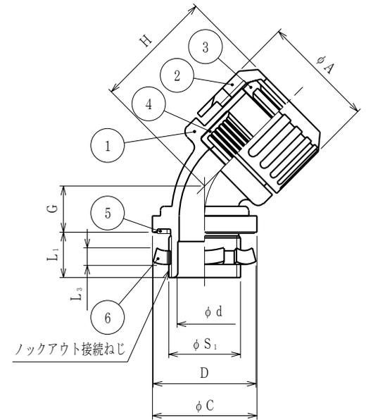
注1. サンフレキROBOをボックス類のノックアウトに接続するための、45°形のメートル細目ねじ付きのコネクタです。
