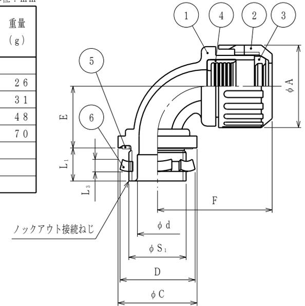
注1. サンフレキROBOをボックス類のロックアウトに接続するための、メートル細目ねじ付き90°形コネクタです。
