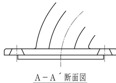
注1. サンフレキROBOをボックス類の穴に接続するための90°形の金属製フランジ付コネクタです。
