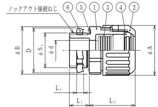
注1. サンフレキROBOをボックス類のロックアウトに接続するための、ストレート形の薄鋼電線管ねじ付きのコネクタです。
