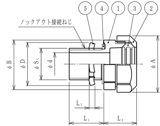
注1. サンフレキROBOをボックス類のロックアウトに接続するためのストレート形の管用平行ねじ付きのねじ長コネクタです。
