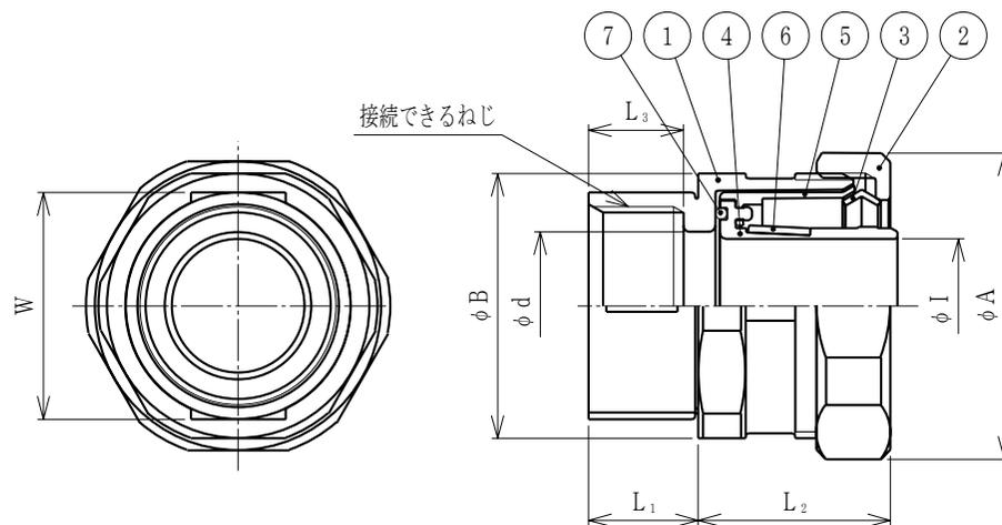
注1. サンフレキROBO Type NSBSを厚鋼電線管に接続するための、ストレート形の厚鋼電線管ねじ付きコンビネーションカップリングです。
