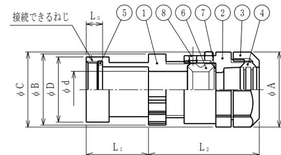
注1. サンフレキROBOをバックシェル (又はプラグ) なしのMSコネクタに接続するための、ストレート形のケーブルグランド式カップリングです。
