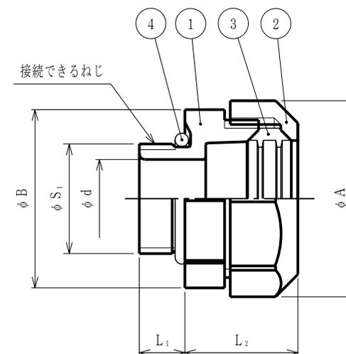
注1. サンフレキROBOをリミットスイッチ等のめねじに接続するための、ストレート形の管用平行ねじ付きコネクタです。
