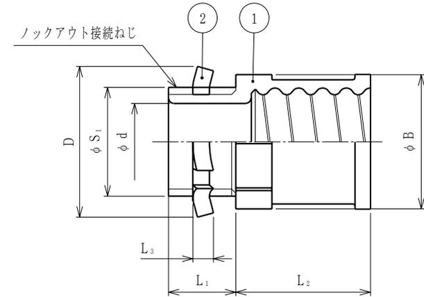
注1. サンフレキNTを、ボックス類のロックアウトに接続するための非防水仕様のストレート形管用平行ねじ付き樹脂製コネクタです。
