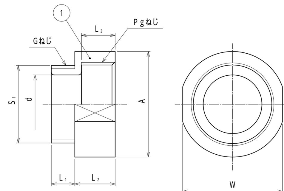
注1. Pgおねじを管用平行おねじに変換するための、樹脂製変換ハブです。
