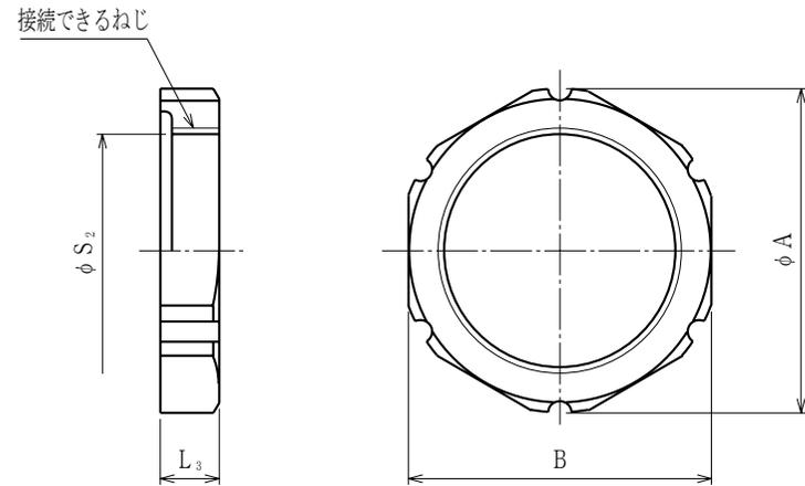
注1. 電線管及び電線管用コネクタをボックス類のノックアウトに接続するために使用する管用平行ねじ（厚鋼電線管ねじ）用の樹脂製ロックナットです。
