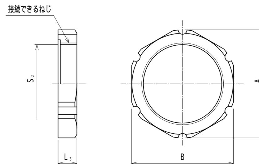
注1. 電線管及び電線管用コネクタをボックス類のロックアウトに接続するために使用するPgねじ用の樹脂製ロックナットです。
