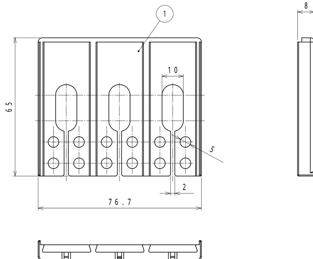
注1. ブレーカーの端子カバーに取り付けて、異物混入及び感電防止のためのパッキンです。
