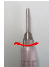
交換するノズルを取付け、ナットを締付ける
