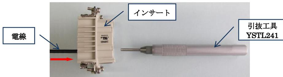
2. 引抜き工具 YSTL241 をそのまま真っすぐにインサートの奥まで押し込んでください。引抜き工具の先端ノズルがコンタクトのリテーナを縮め、さらに引抜き工具内部のバネの力により、コンタクトをインサートから押し出します。
