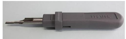
2. 工具先端部をインサートの電線接続側から、垂直に引抜き工具挿入部(青色部)に入れ、止まるまで差し込んでください。
