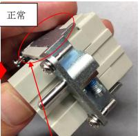
フレーム面と固定タブが 同一面になれば完了です。 (裏側も同じにします。)
